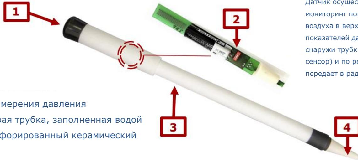
Датчик осуществляет непрерывный мониторинг показателей давления воздуха в верхней части трубки и показателей давления воздуха снаружи трубки (через контрольный сенсор) и по результатам анализа передает в радиоканал сообщения
